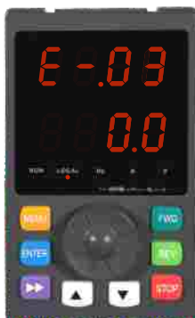
Figura 4-5 Estado de exibição de alarme de falha
