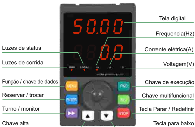
Figura 4-3 Diagrama do painel de controle
