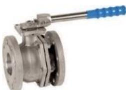
**Válvula macho esférico INOX de passagem total de 2 peças, design "à prova de fogo", flanges DIN PN-40 montagem direta de atuadores de acordo com ISO 5211**
