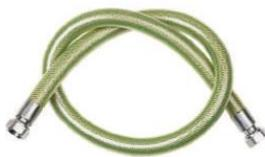
Tubo flexível de aço inoxidável AISI 316L. Malha trançada com fio de aço inoxidável AISI 304. Cobertura plástica de PVC retrátil, conforme UNE-EN 14800. Conexão fêmea-fêmea porca de união, Rp1 / 2 "x Rp1 / 2" ISO 7/1 (UNE-EN 10266). Pressão máxima de trabalho 0,5 bar. Comprimento disponível 1m.
