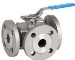
**Válvula macho esférico INOX de 3 vias de passagem total / porta 2540 tipo L / porta 2541 tipo T Flanges DIN PN 40 ≤ DN50 / Flanges DIN PN 16 > DN50**
