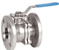
**Válvula macho esférico INOX de passagem total de 2 peças "à prova de fogo" direto de atuadores S/ISO 5211. Flanges DIN PN -40 ≤ DN -50 / Flanges DIN PN -16 > DN -50**
